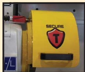
Garde au dessus du mandrin avec l'interrupteur de sécurité catégorie 1.
