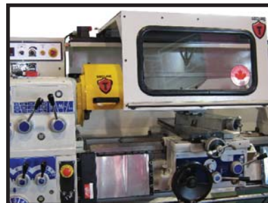
Garde au dessus du chariot avec verrou pour une protection sur toute la distance de travail avec l'interrupteur de sécurité de catégorie 1.
